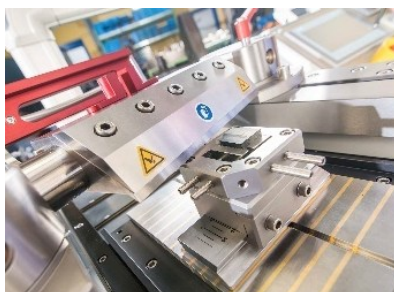
Schräg gestelltes Messer erlaubt einen ziehenden Schnitt
