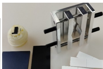
Universal Probenhalter für Folien und Rundproben
