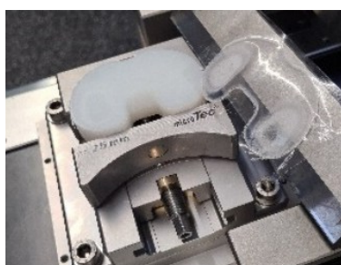
Individuelle Probenhalter am Beispiel eines Kniegelenks
