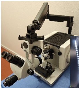
Mikroskopische Kontrolle der An-schnittfläche auf Oberflächenqualität.
