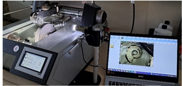
Probentrennung und Dünnschliffherstellung
