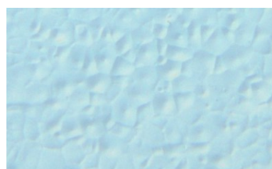
Abb.6.32 Polyamid Sphärolithe im Anschliff, Auflicht, geätzt - Interferenzkontrast
