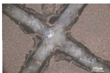
Filter Keramik im Durchlicht/ Auflicht
