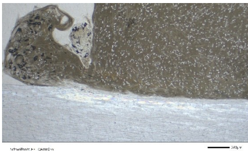
Dünnschliff einer Kunststoffschweißnaht Durchlicht Hellfeld.
