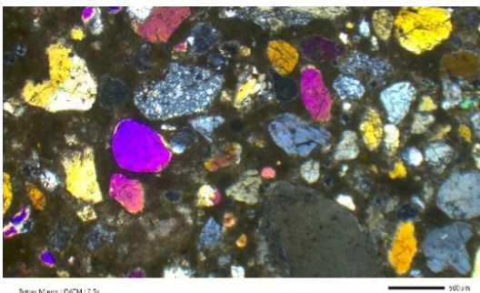
Beton im Durchlicht Polarisationskontrast (Lambda)
