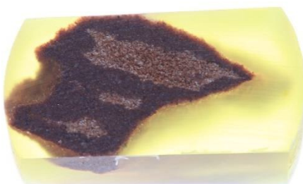
Ungenügende Infiltration, Sandstein Baustoff
