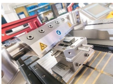
Schräg gestelltes Messer erlaubt einen ziehenden Schnitt
