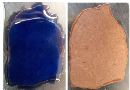
Ungenügende Infiltration und Nachinfiltration für optimale Ergebnisse
